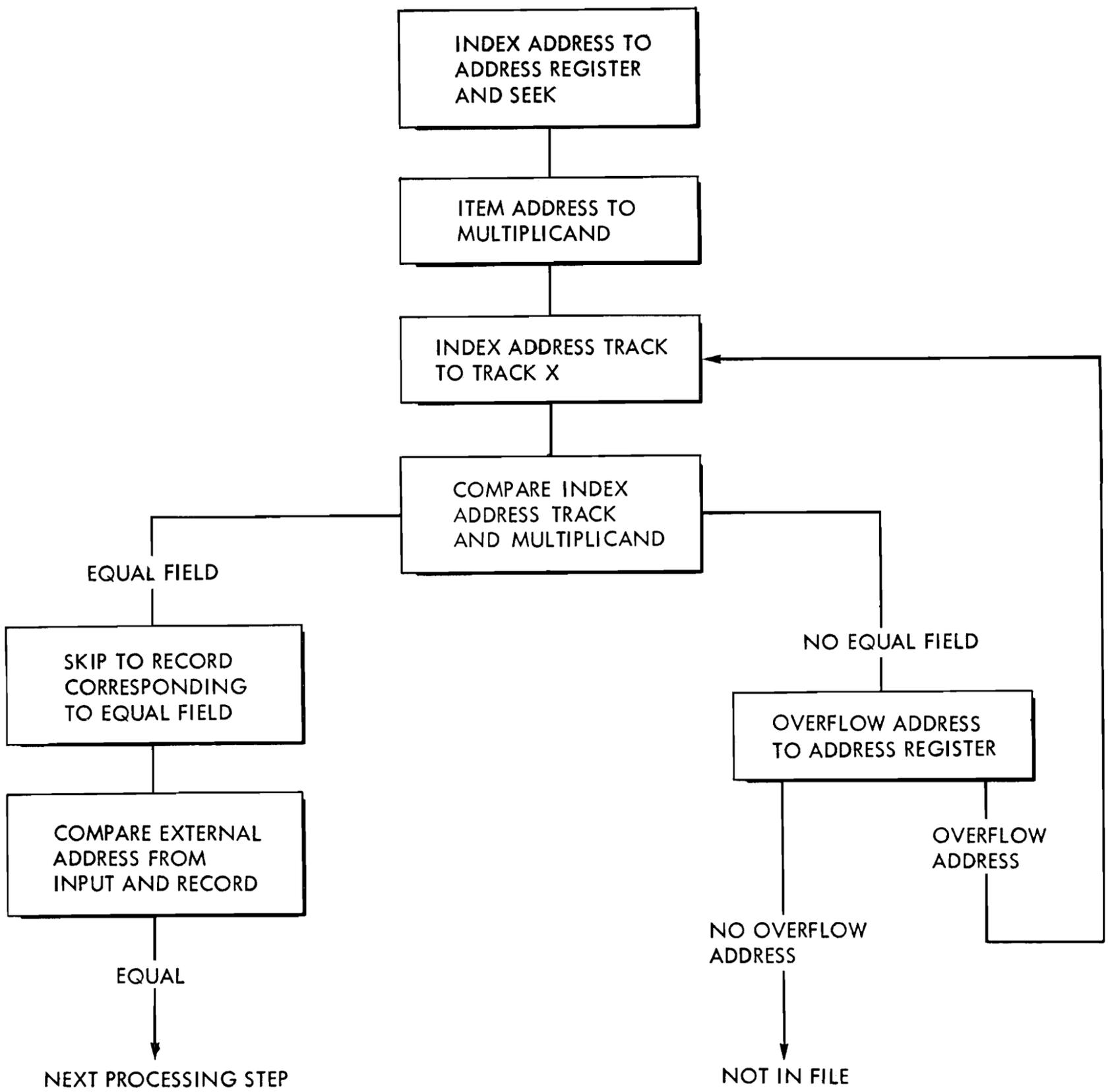
FIGURE 42. BLOCK DIAGRAM — LOCATING THE RECORD DURING PROCESSING
