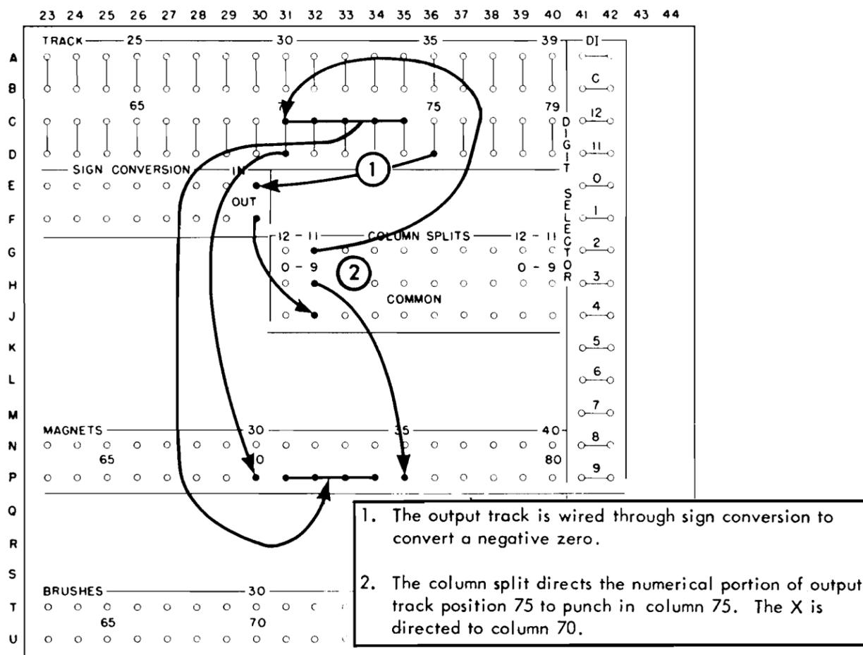
FIGURE 92. PUNCH NEGATIVE X OVER HIGH-ORDER POSITION
