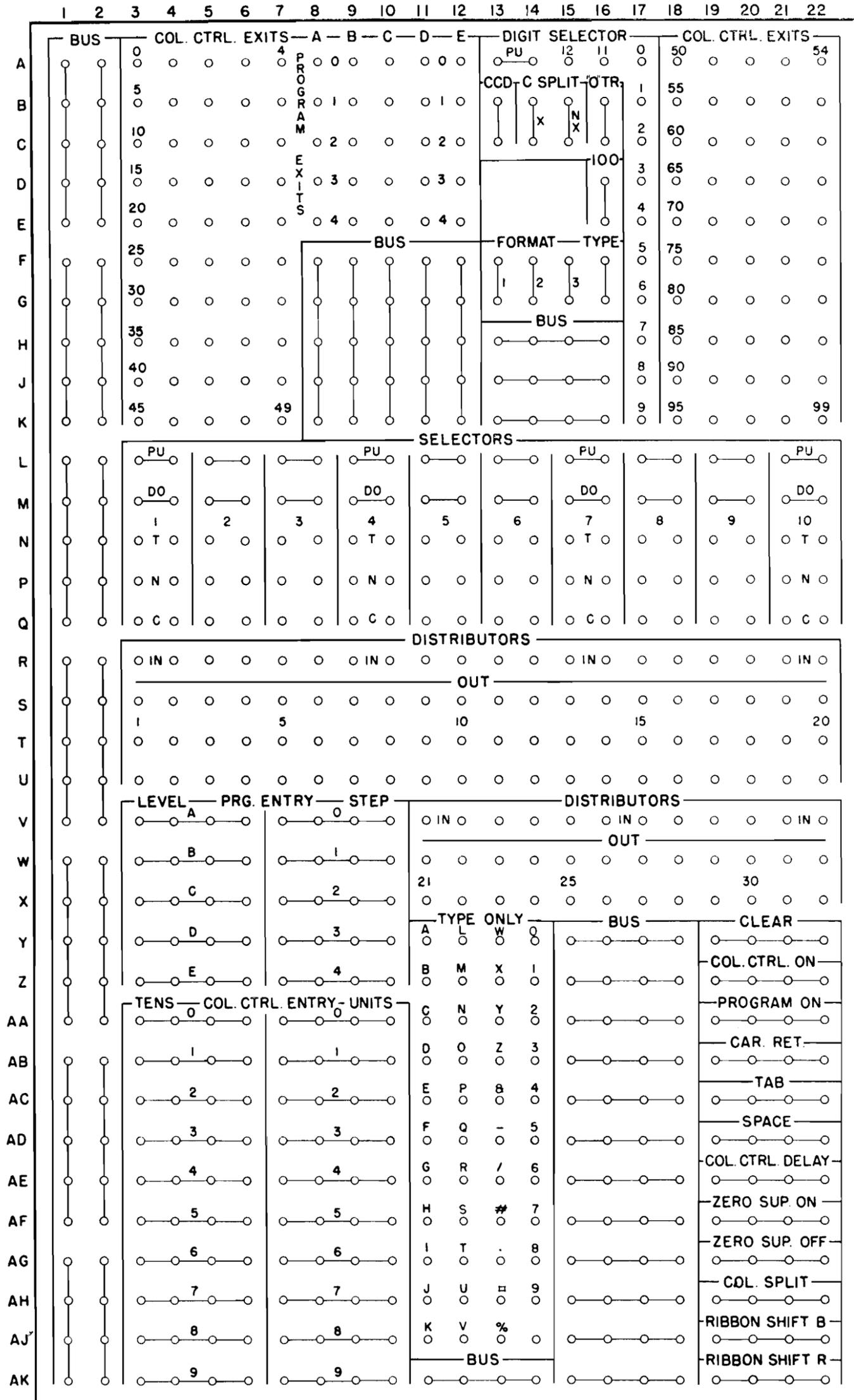
FIGURE 57. 380 TYPEWRITER CONTROL PANEL
