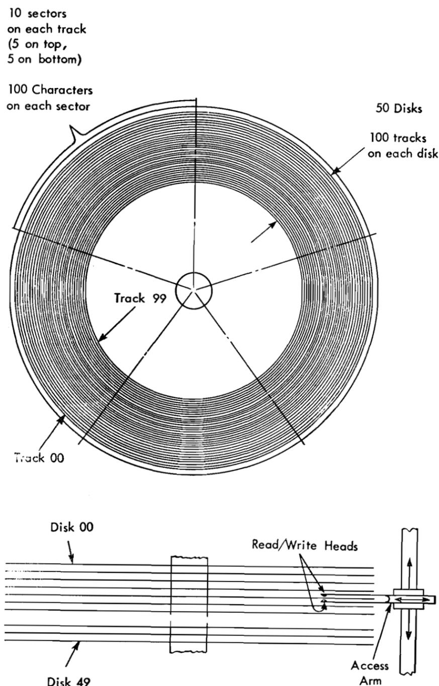
FIGURE 4. SCHEMATIC OF DISK STORAGE
