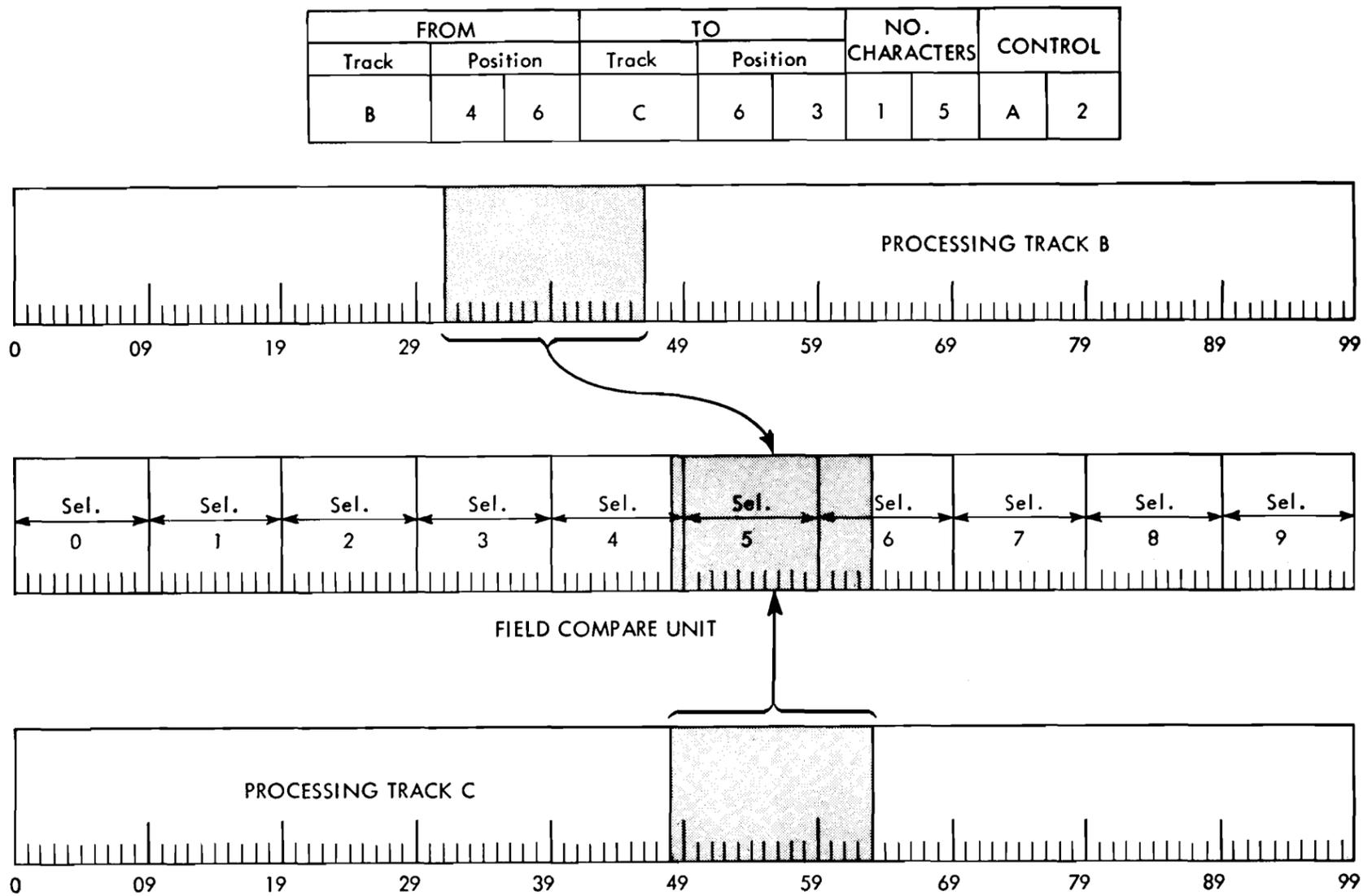
FIGURE 17. SCHEMATIC OF FIELD COMPARE OPERATION
