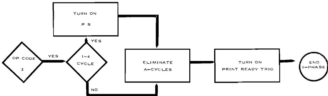
DURING THE I-PHASE CYCLE THAT THE B-REG WM TEST IS YES, THE OP CODE TEST IS MADE.
