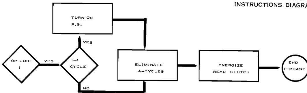
DURING THE I-PHASE CYCLE THAT THE B-REG WM TEST IS YES, THE OP CODE TEST IS MADE.
