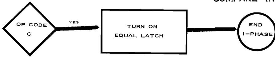
DURING THE I-PHASE CYCLE THAT THE B-REG WM TEST IS YES, THE OP CODE TEST IS MADE.
