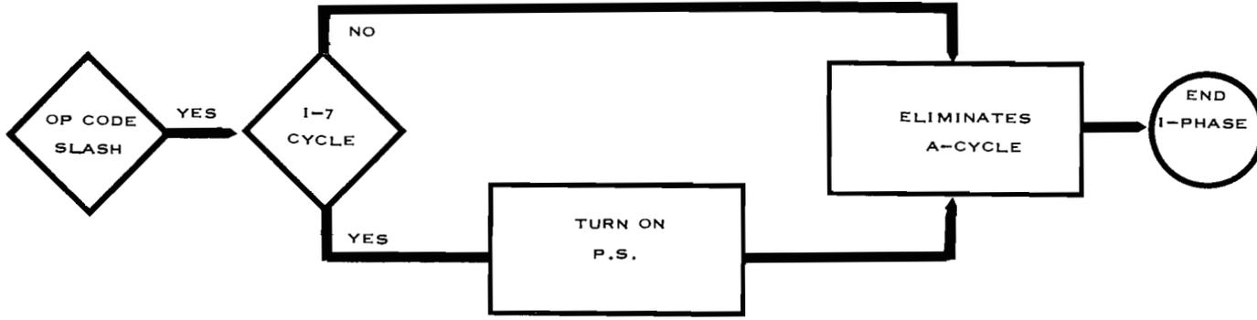
DURING THE I-PHASE CYCLE THAT THE B-REG WM TEST IS YES, THE OP CODE TEST IS MADE.
