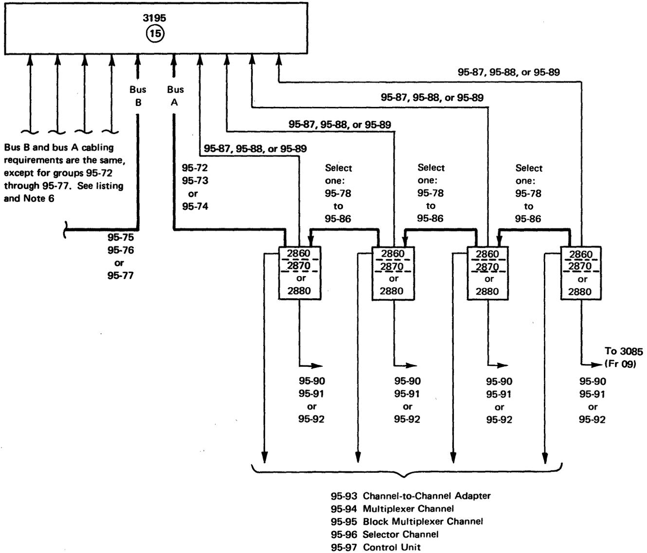
**SYSTEM/360 MODEL 195 CABLING SCHEMATIC—CHANNELS**
